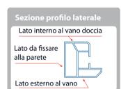
Prendere il profilo laterale sinistro e posizionarlo, come indicato in figura, con la parte più larga rivolta all'esterno. Inserire una staffa in ferro e una squadretta ad angolo (quest'ultima contrassegnata dalla lettera "A") nella parte alta (Fig. 3.1 e Fig. 3.2) e una squadretta ad angolo, contrassegnata dal numero "0", nella parte bassa (Fig. 3.3).
