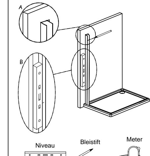
3. Bohren Sie den Löchern mit dem Bohrer und setzen Sie den Ankern.
