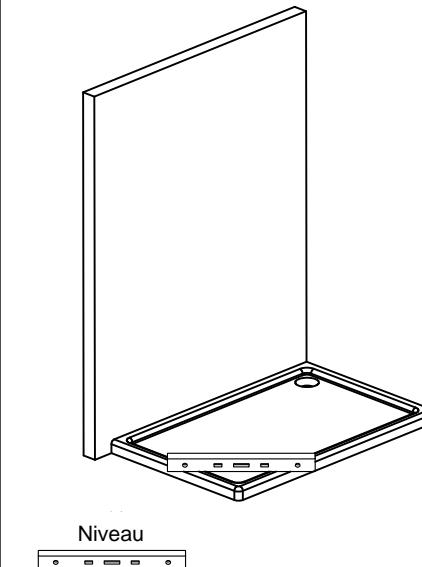
2. Legen Sie die Wandprofil in den angegebenen Stellungen. Achten Sie darauf dass sie perfekt vertikal sind mit der Niveau, und die Positionen markieren.
