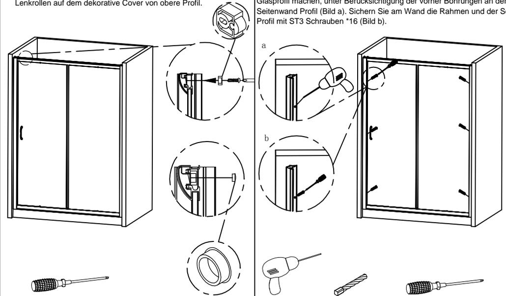
12. Mit den Bohrmaschine einen Lochern von Ø3 auf der vertikalen Glasprofil machen, unter Berücksichtigung der vorher Bohrungen an der Seitenwand Profil (Bild a). Sichern Sie am Wand die Rahmen und der Scheibe Profil mit ST3 Schrauben \*16 (Bild b).
