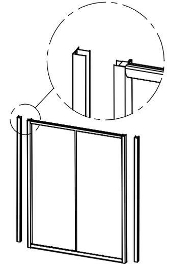
9. Der Wandprofil und der Rahmen an der Wand mit 3 Schrauben ST4\*32 befestigen.
