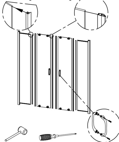
7.1. Legen Sie die unteren Rand des Tür Festverglasung in der unteren Führungsprofil. (Bild A). Befestigen die Glasprofil des Glases an untere Führungsprofil mit ST4 \* 35 Schrauben (Bild B).
