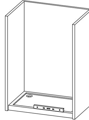
2. Legen Sie die Wandprofil auf den Duschwanne (Bild a), dann das Hochformat mit der Wasserwaage einstellen (Bild b) und mit einem Bleistift die Punkte markieren wo die Bohrungen markiert werden müssen.
