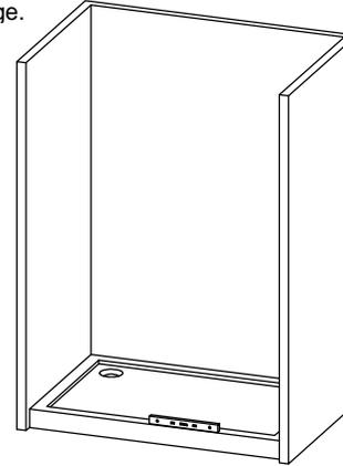
2. Legen Sie die Wandprofil auf den Duschtasse (Bild a), dann das Hochformat mit der Wasserwaage einstellen (Bild b) und mit einem Bleistift die Punkte markieren wo die Bohrungen machen wären müssen.
