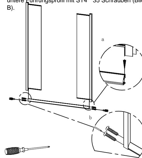
8.1. Die obere Führungsprofil an die Festverglasung anwenden (Bild A), und mit Schrauben ST4 \* 35 in der Seitenprofil mit der oberen Führungsprofil sichern (Bild B).
