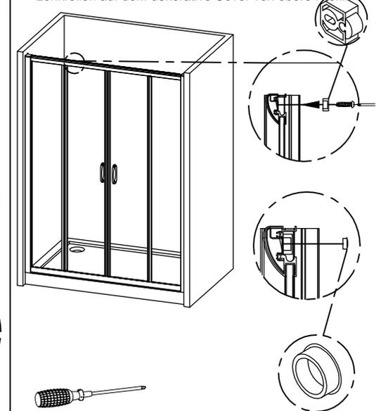
13.1 Mit den Bohrmaschine einen Lochern von Ø3 auf der vertikalen Glasprofil machen, unter Berücksichtigung der vorher Bohrungen an der Seitenwand Profil (a). Befestigen der Profil und Wandprofil an die Wand mit ST3 \* 16 Schrauben (b).
