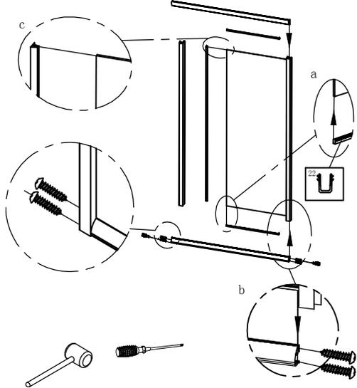
6. Installieren Sie den oberen und unteren Lagern an der Schiebetür wie im Bild.
