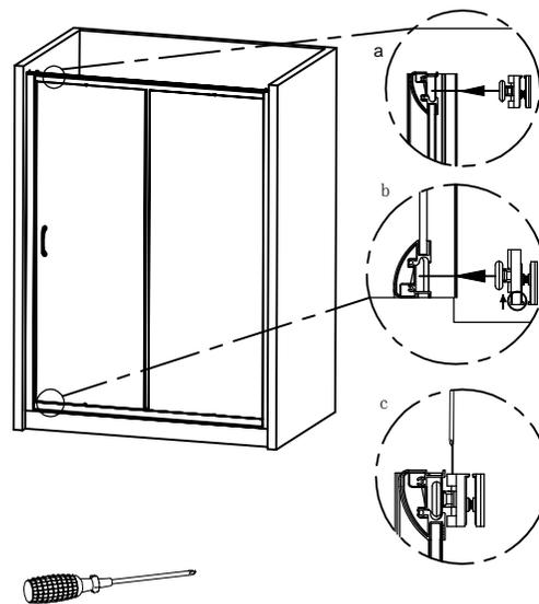
11. Passen Sie die Position der Schiebetür und ziehen Sie die Lenkrollen auf dem dekorative Cover von obere Profil.
