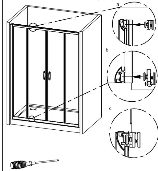
12. Passen Sie die Position der Schiebetür und ziehen Sie die Lenkrollen auf dem dekorative Cover von obere Profil.
