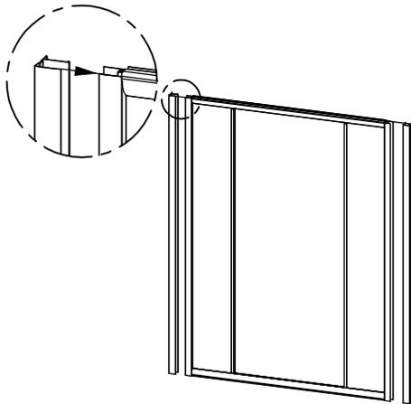
10. Der Wandprofil und der Rahmen an der Wand mit 3 Schrauben ST4\*32 befestigen.
