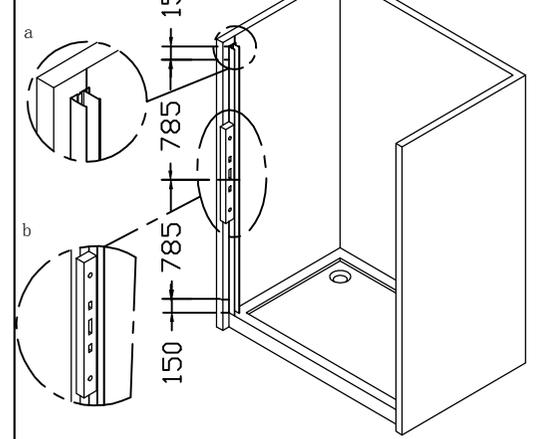
3. Die Wandprofil entfernen, 6 Löcher  $\Phi 6$  bohren (Bild a) und die 6 Ankern einsetzen (Bild b).
