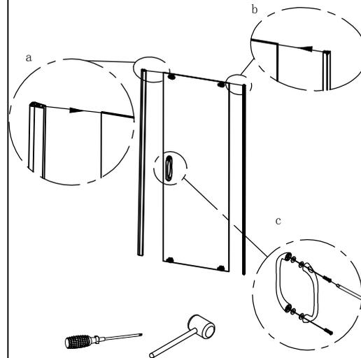
8. Der Wandprofil an Rahmens Profil auf beiden Seiten einsetzen.
