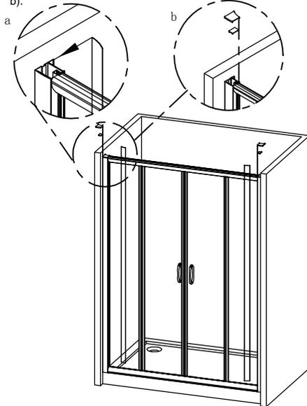
15. Reinigen des Glases und Anwendung der Silikonabdruck auf die Seiten des Profils und Duschwanne.
