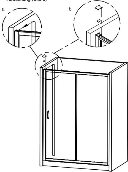
14. Reinigen des Glases und Anwendung der Silikonabdruck auf die Seiten des Profils und Duschwanne.
