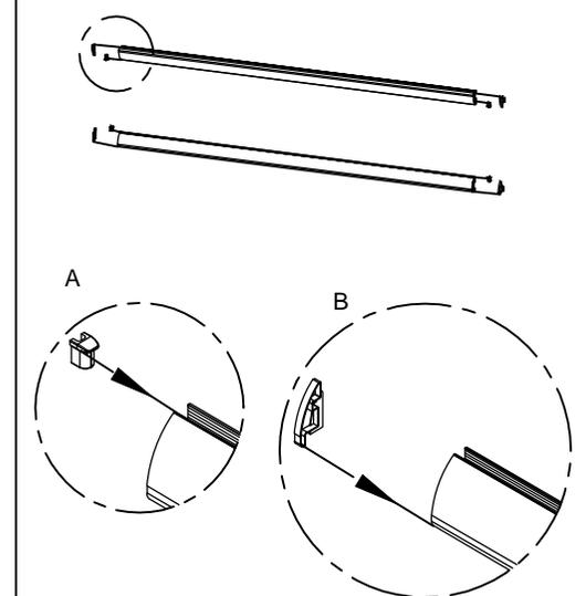
5.1. Installieren Sie den oberen und unteren Lagern an der Schiebetür wie im Bild.
