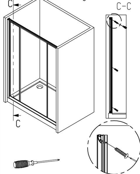
11.1. Legen Sie die oberen Lagern in der oberen horizontalen Pfoste (Bild A). Drücken Sie die kleinen Knopf unterhalb des Lagers und platzieren Sie auf der unteren Schiene (Bild B). Die oberen Lagern durch die Einstellschrauben einstellen (Bild C).
