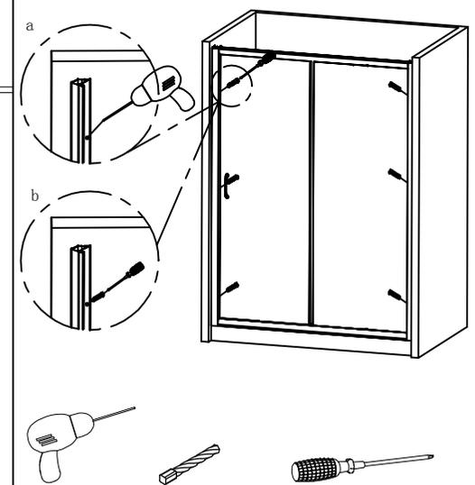
13. Installieren die dekorative Profil (Bild a) und wenden Sie in richtige Position die dekorative Abdeckung und die innere Abdeckung (Bild b)
