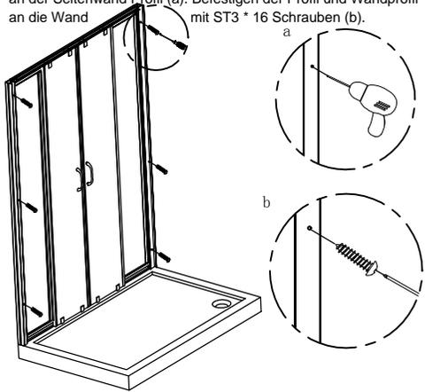
Fissare il profilo e il profilo muro sulla parete con le viti ST3\*16 (b)
