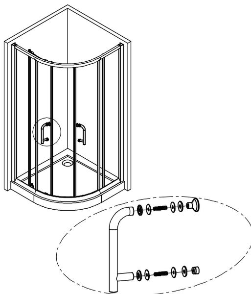
11. (1) Considérant les trous précédemment faites sur les montants verticaux au mur, percer et fixer la structure avec toutes les vis 3.5 \* 10 puis mettre les cache-vis.
