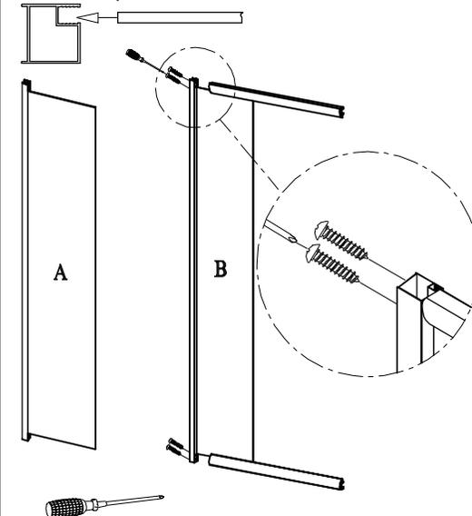
3.(1) Placer les profils parclose et les percer avec une mèche pour métaux de 2.8. Visser les profils avec les vis 3.5\*10 (photo A)
