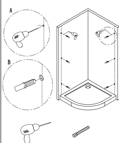
7. Fixer le montant verticale avec les vis fournies 4\*32 (photo A), après emboîter le joint d'étanchéité à l'extrémité du verre fixe. La lèvres du joint doit être placée à l'intérieur de la douche enclos. (photo B)
