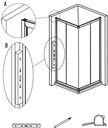
6. Préparer les montants verticaux au mur à plomb sur le bac à douche après avoir pris les bonnes mesures. Faire des trous avec la mèche de 6mm et insérer les morceaux de vis.
