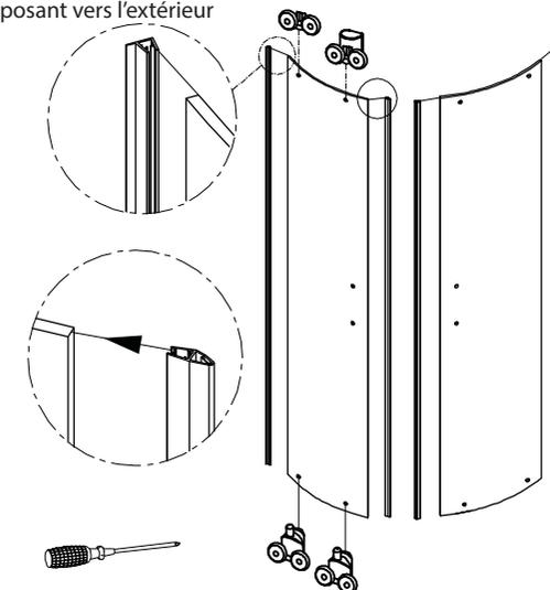
9. (1) installer les roulettes supérieures à l'intérieur de la glissière supérieure courbée (photo A).
