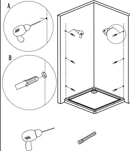
7. Fixer le montant verticale avec les vis fournies 4\*32 (photo A), après emboîter le joint d'étanchéité à l'extrémité du verre fixe (photo B). La lèvres du joint doit être placée à l'intérieur de la douche enclos.
