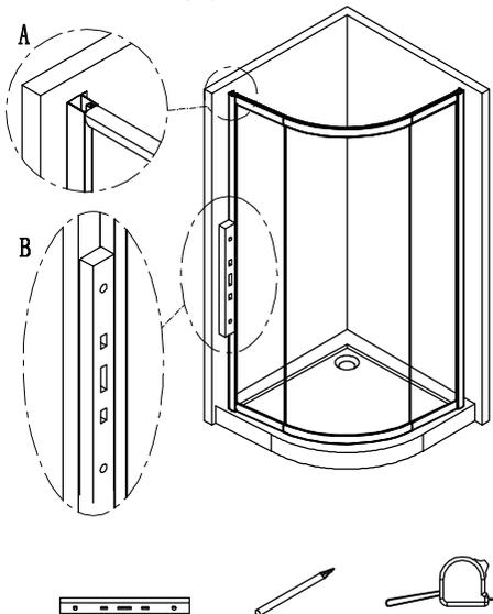
6. Préparer les montants verticaux au mur à plomb sur le bac à douche après avoir pris les bonnes mesures. Faire des trous avec la mèche de 6mm et insérer les morceaux de vis.
