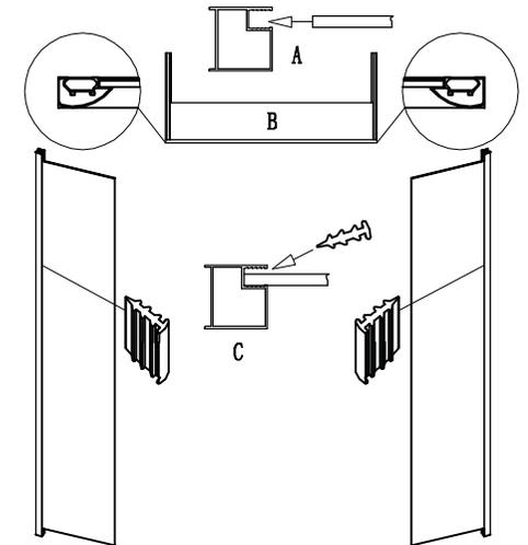
4. (1) Placer les profils parclose et les percer avec une mèche pour métaux de 2.8. Visser les profils parclose avec les vis 3.5\*10 (photo A)
