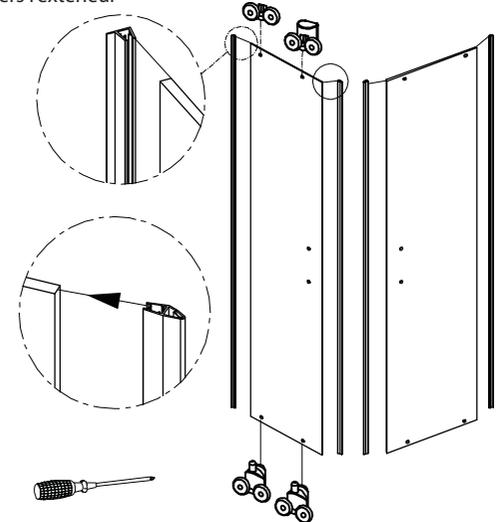
9. (1) installer les roulettes supérieures à l'intérieur du montant horizontal en haut (photo A).
