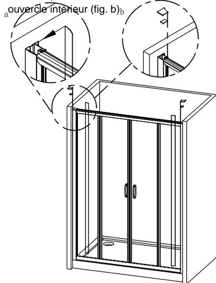
Nettoyer la vitre et appliquer le moule silicone sur les côtés des profils et plateau douche
