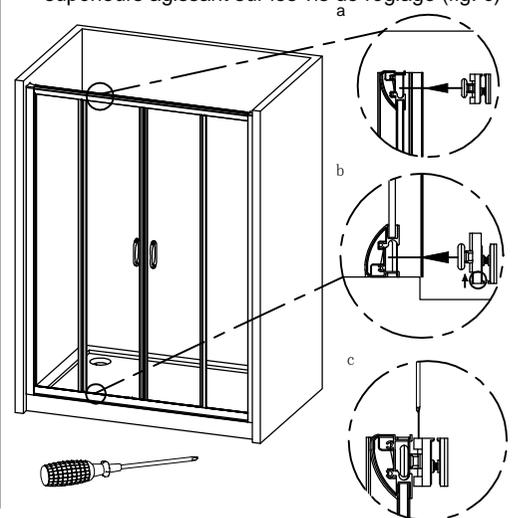
12. Régler la position de la porte coulissante et serrer le pivot de verrouillage sur la couverture décorative du profil supérieure
