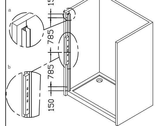
4. Fig. a. Insérer les joints dans les profils de guidage supérieures et inférieures. Répétez l'opération pour les jonctions du profil droite et à gauche indiqué dans la fig. b.
