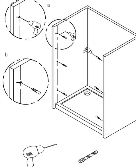
2. Placer le profil mural sur le plateau douche (voir fig. a), puis régler la position verticale avec le niveau (fig. b) et marquer avec un crayon les points sur lesquels faire des trous
