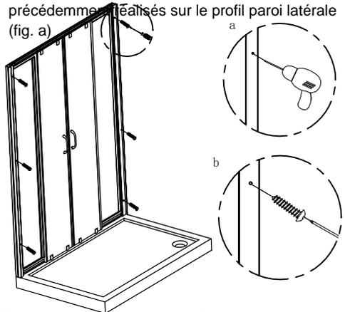
Fixer au mur le cadre et le profil coulissant avec les vis ST3\*16 (fig. b)
