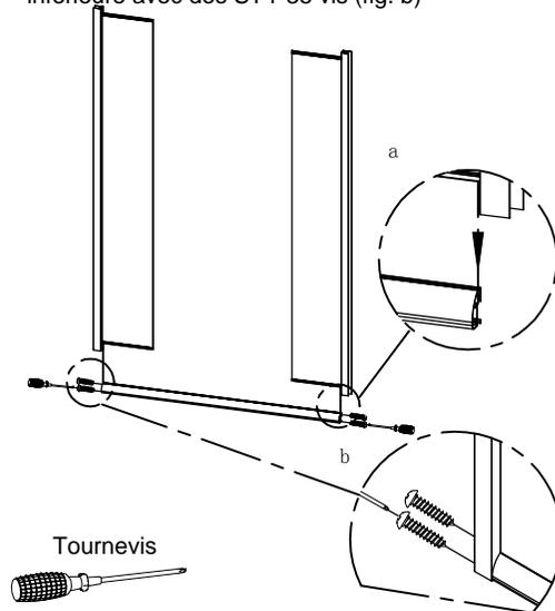
8.1. Appliquer le profil du guide supérieur à la porte fixe (fig. a), et fixer avec des ST4\*35 vis le profil latéral avec le profil de guidage supérieure (fig. b)
