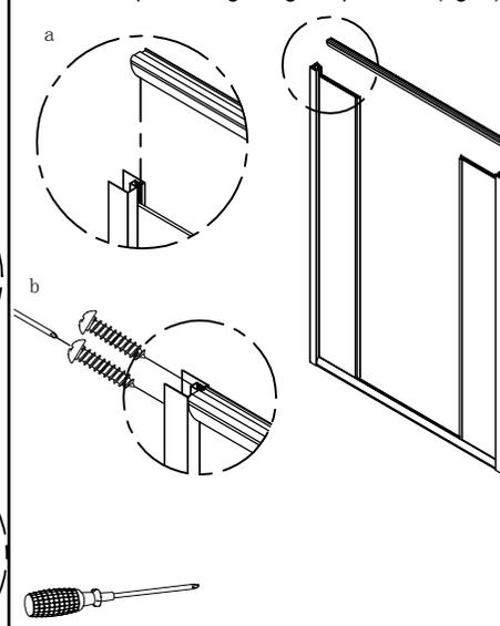
9. Superposition, sur les deux côtés, du profil de mur au profil du cadre.
