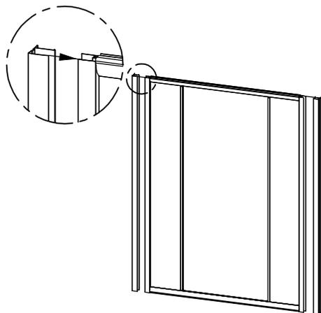
10. Fixer les profils murale et le cadre au mur avec 3 vis de ST4\*32
