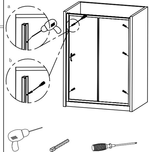
13. Installer le profil décoratif (fig. a) et appliquer dans la bonne position le couvercle décoratif et couvercle intérieur (fig. b)
