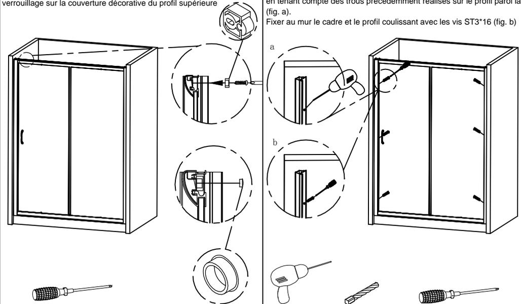
12. Effectuer avec la foreuse des trous Ø3 sur le profil du verre verticale en tenant compte des trous précédemment réalisés sur le profil paroi latérale (fig. a).
