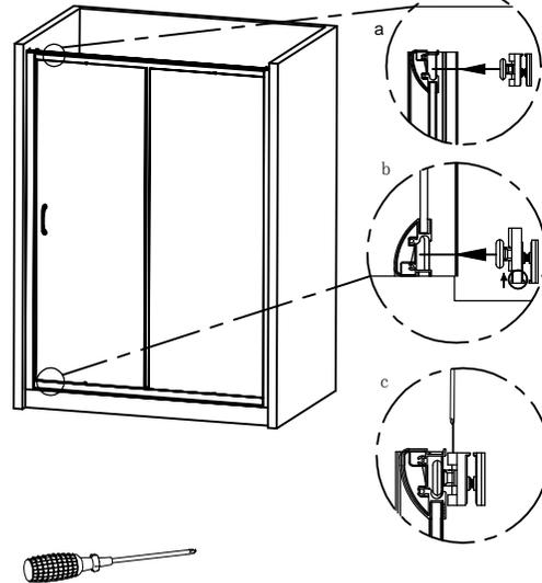
11. Régler la position de la porte coulissante et serrer le pivot de verrouillage sur la couverture décorative du profil supérieure
