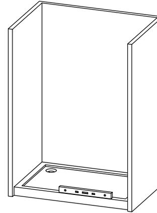
3. Enlever le profil mural, percer 6 trous  $\Phi 6$  (fig. a) et mettre les 6 ancrés (voir fig. b)
