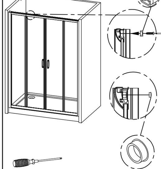
13.1 Effectuer avec la foreuse des trous Ø3 sur le profil du verre verticale en tenant compte des trous précédemment réalisés sur le profil paroi latérale (fig. a)
