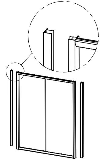
9. Fixer le profil mur et le cadre au mur avec le 3 vis ST4\*32
