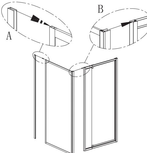
4. Selon la position du profilé d'angle, percer des 3 mm trous aux endroits désignés puis fixer le profil mural au parois fixe en utilisant les vis ST3.9\*12.
