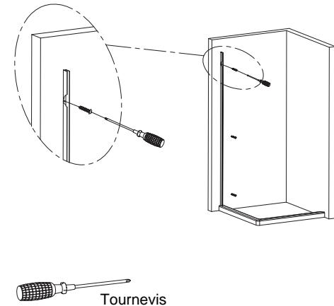
8. Placer le paroi au mur, selon les trous du profilé mural, percer un trou de 3 mm sur le profil mural (img. A) ensuite fixer avec la vis ST3.9\*12 avec couvercle (img. B).
